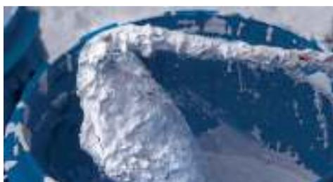
**6.** Dopo alcuni giorni di raffreddamento iniziavano il sortimento delle pietre calcinate. Queste, bagnate con acqua pulita e rimestate con la marra si trasforma-
